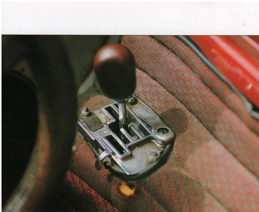
Alcuni dettagli dello stretto ed essenziale abitacolo della 312 B2: la corta leva del cambio a settori - che accomunava la F1 a tutta la produzione Ferrari stradale - (da notare il pomello in legno) e il volante MOMO a tre razze, rivestito in morbida pelle nera antiscivolo.
