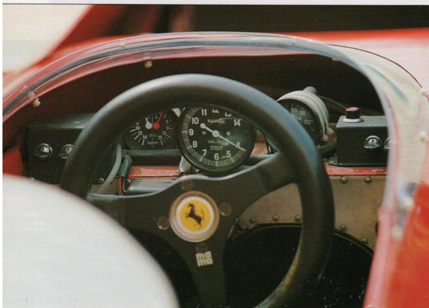
Alcuni dettagli dello stretto ed essenziale abitacolo della 312 B2: la corta leva del cambio a settori - che accomunava la F1 a tutta la produzione Ferrari stradale - (da notare il pomello in legno) e il volante MOMO a tre razze, rivestito in morbida pelle nera antiscivolo.
